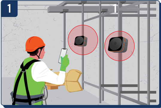
1 양생작업 전 양생공간 내부에 일산화탄소 감지기 설치 (면적을 고려하여 양생작업 내부에 최소 2대이상 설치) 감지기 설치 위치 선정 시 양생작업장 내 일산화탄소 발생 특성을 고려
